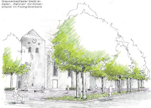
Porphyrpflaster bleibt erhalten, wird aber neu verlegt. Umfeld mit Klinkerpflaster im Fischgräberband
