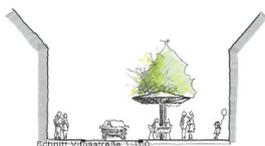
Ab der Overbergstr. wird die Vitusstraße zu einer Einbahnstraße, daraus resultierend kann die Straßbreite deutlich reduziert werden. Gehwege und Straße werden mit Klinkerpflaster versehen. Die höhengleiche
