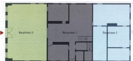
Abb. unten Kernbau und Bauphasen (Quelle: Anna Jaacks, Lisa Specken)
